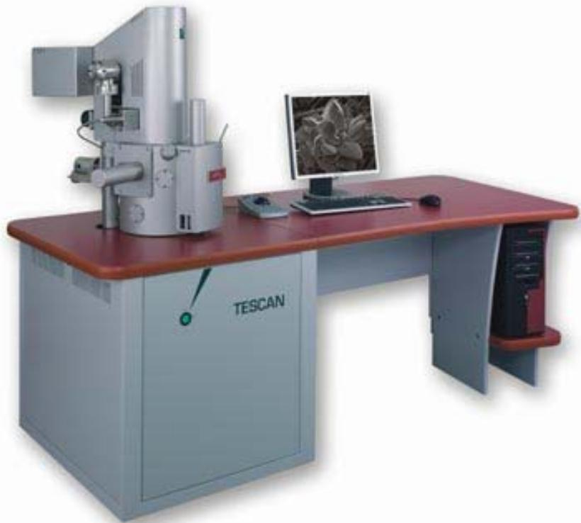
SEM mikroskopi omogućavaju istraživanje mikrostruktura uvećanjem i do 1.000.000 puta.
