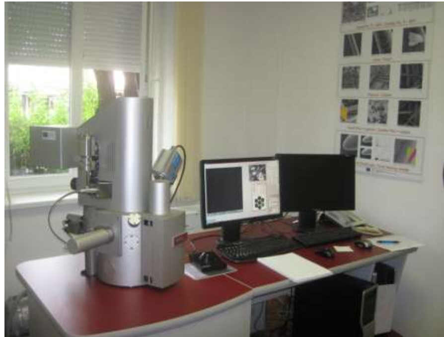
Visokorezolucijski pretražujući elektronski mikroskop (FE-SEM), Tescan, MIRA\\LMU, Češka
