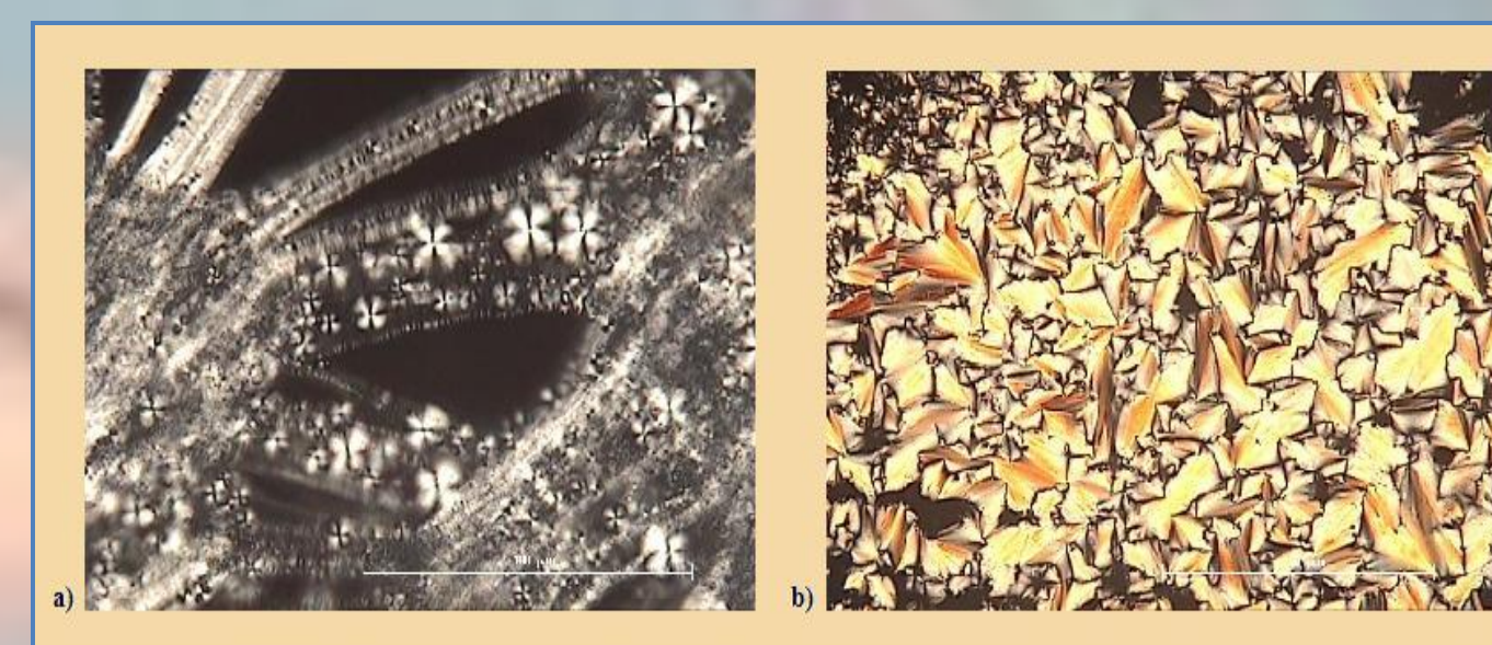
Tekstura lamelarnih faza dodecilpiridinijevog dodecilbenzensulfonata pri zagrijavanju: a ( t/^{\circ}\text{C} = 124.9 ), te b: uzorak ohlađen na sobnu temperaturu. Skala odgovara 100 \mu\text{m} (a) i 250 \mu\text{m} (b).
