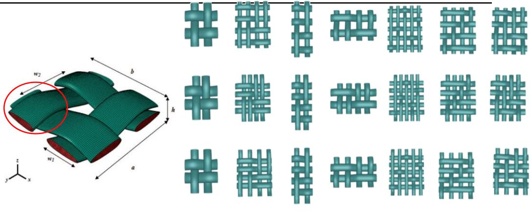
**Kontrolirane karakteristike deformabilnosti** postižu se projektiranjem tkanina određenih konstrukcijskih karakteristika kao što su vez, gustoće niti, sirovinski sastav i konstrukcijske karakteristike osnove i potke, površinska masa i dr.
