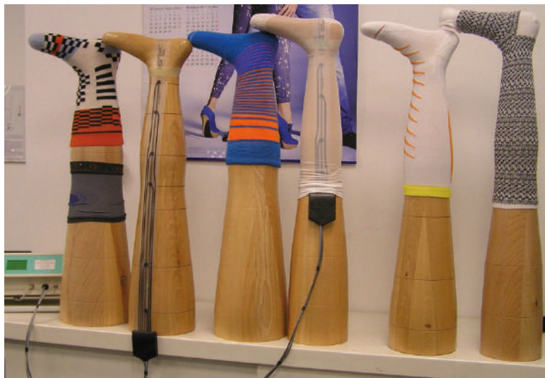
Modeli drvenih noga za mjerjenje kompresivnosti čarapa
