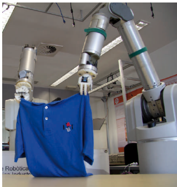
Robotsko hvatanje odjeće mehaničkom hvataljkom
