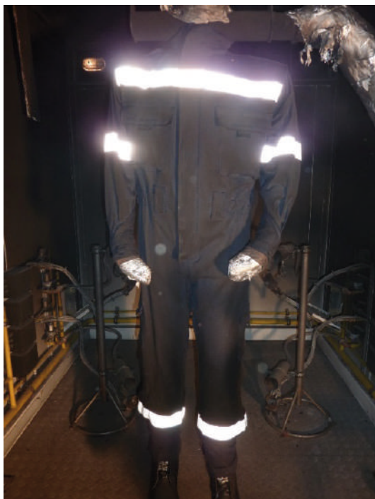
Kombinezon za vatrogasce nakon ispitivanja na požarnoj lutki
