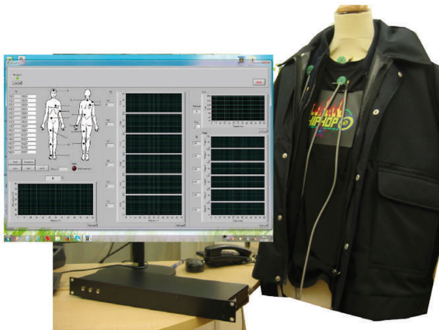
Integrirani uređaj za mjerenje fizioloških parametara ljudskog tijela
