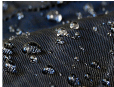
Obrada plazmom za dobivanje hidrofobnih i antimikrobnih svojstava
