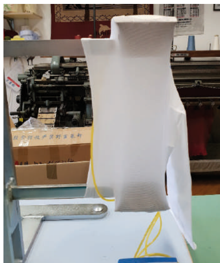
Kompresijske škare za mjerjenje kompresivnosti cjevastih elastičnih pletiva
