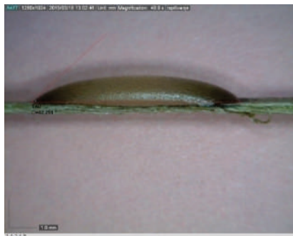
Mikroskopska analiza bočne (lijevo) i gornje strane (desno) skrtnute kapi smole na visoko orijentiranoj pređi kod vrednovanja kvalitete tehničkih vlakana za ojačanje biokompozita
