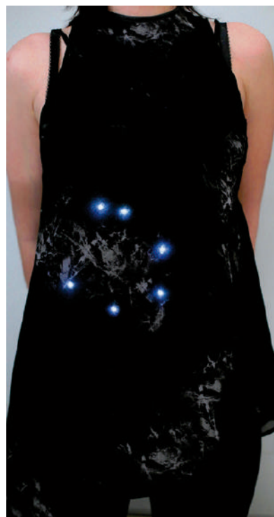
Projektirana e-odjeća s ugrađenim svjetlećim diodama
