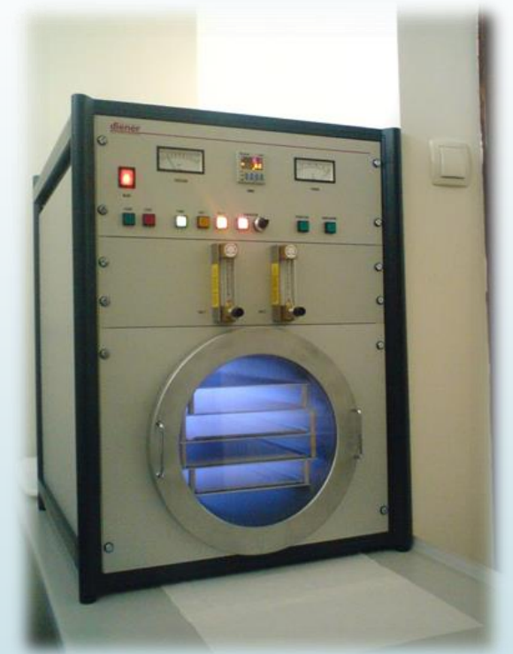
Niskotlačni plazma uređaj tip NANO LF-40 kHz, tt. Diener Electronic GmbH
