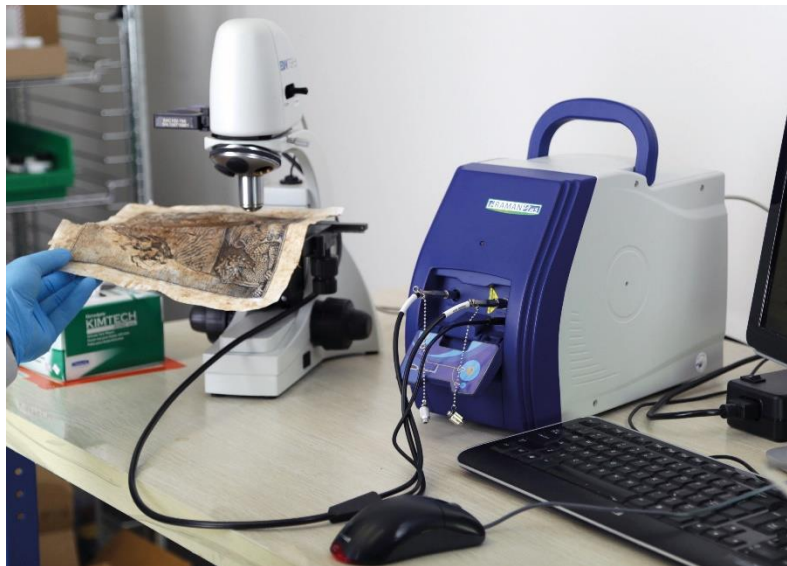
Slika 3: Identifikacija forenzičkih materijala pomoću prijenosnog Raman uređaja
